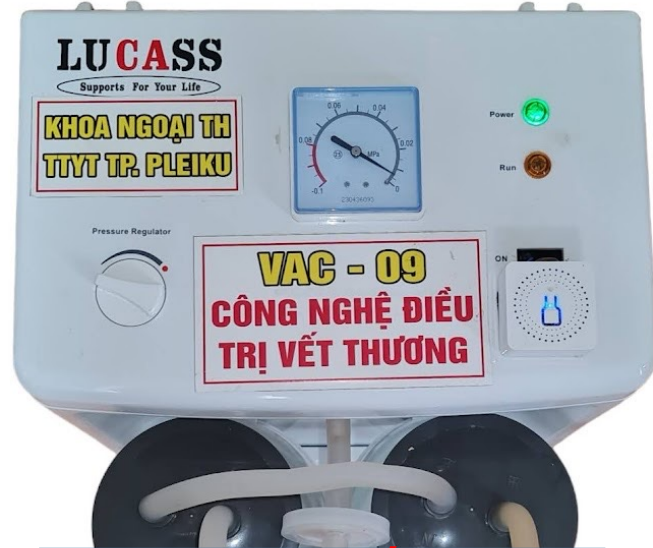
Máy VAC tự chế từ máy hút dịch LUCASS, công tắc hẹn giờ
